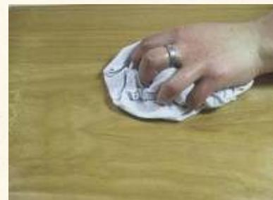
Nach 15- 30 Minuten wird das an der Oberfläche des Holzes stehende Öl mit einem Lappen oder maschinell mit einem Pad abgerieben
